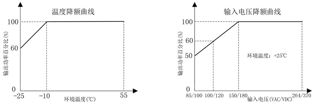
注 1: 当输入电压低于 150VAC/180VDC 时, 需在温度降额基础上进行电压降额;
